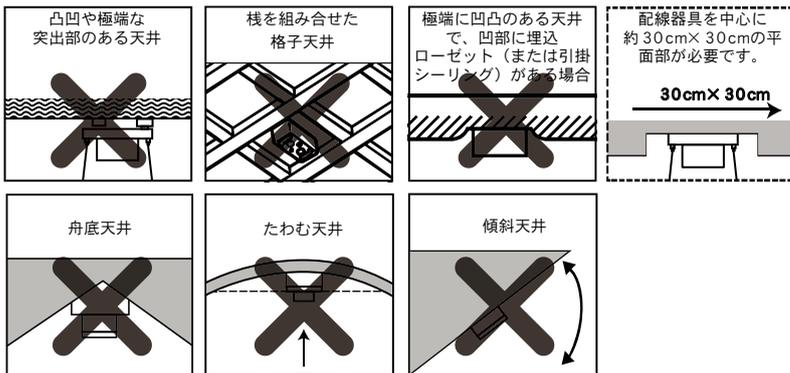
配線器具は必ず丈夫な天井面に確実に取り付けてください。
