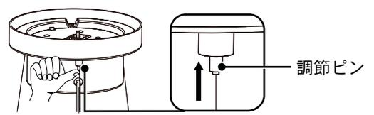
※ワイヤー3本と電源コード1本を調整して器具を水平にしてください。
