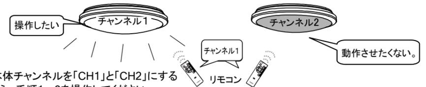
※照明器具が2台設置されていて、それぞれの本体チャンネルを「CH1」と「CH2」にする場合、1台の照明器具の壁スイッチはOFFしてから、手順1~3を操作してください。
