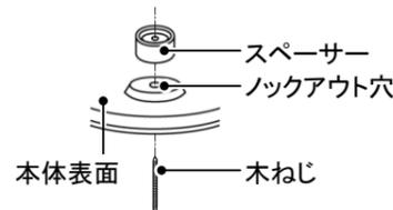
リモコン受信部側が傾斜方向の下側に位置するように、取り付けてください。
